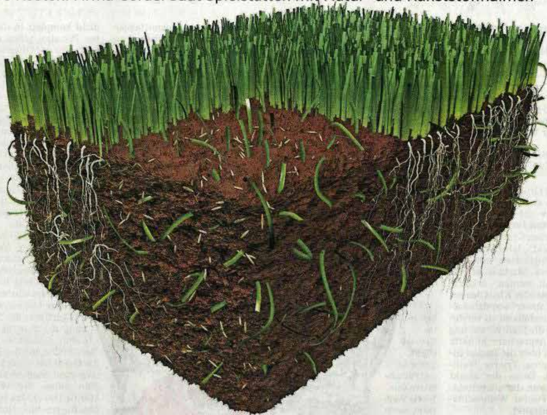
Die Darstellung zeigt die Verteilung der Kunstfaserhalme in der Tragschicht des Naturrasens.
